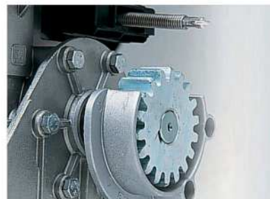
Detalle final de carrera y protección rueda dentada
